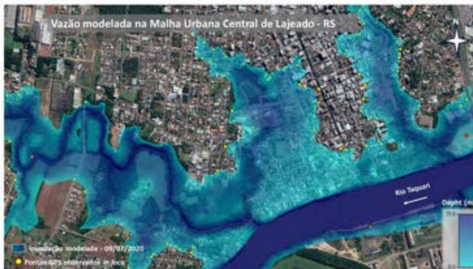
Figura 59: Propagação da mancha de inundação cheia de 09 de julho de 2020 e aproximação de cotas observadas para validação de vazões modeladas.
